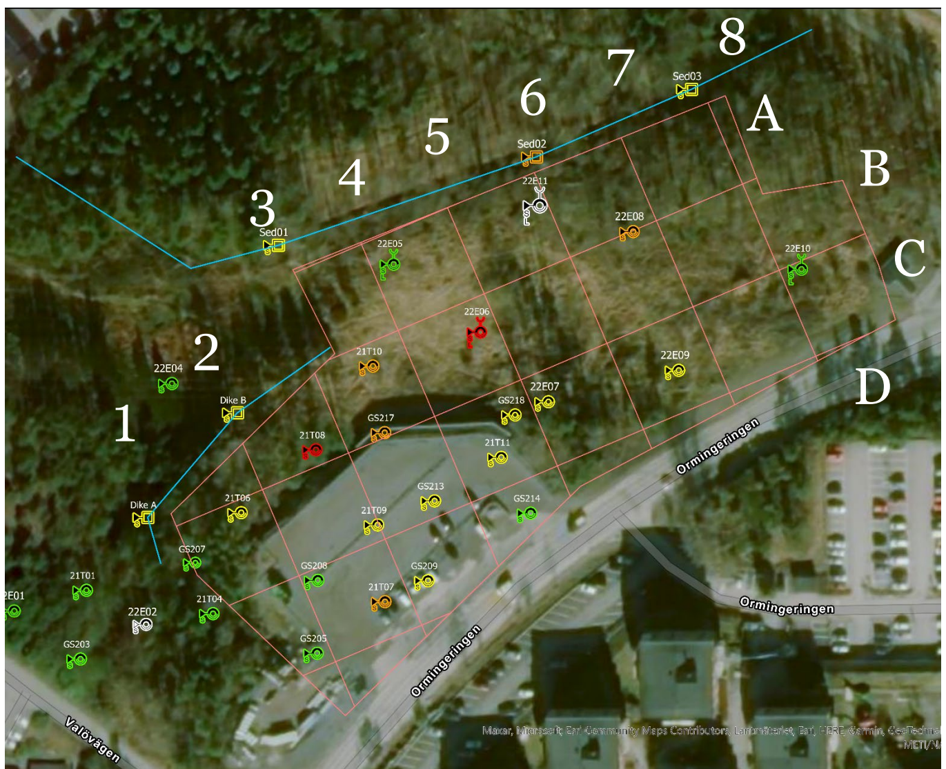
Figur 2. Karta med rutnät för den bedömda utbredningen av den f.d. deponin. Grön provpunkt = halter under KM, Gul punkt = halter över KM, Orange punkt = halter över MKM, Röd punkt = halter över FA.
